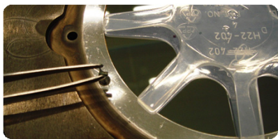
Abb. 3: Klemmvorrichtung für 4"-Wafer im Einsatz
