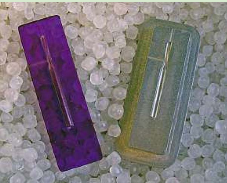
Un modèle de la fraise obtenu par stéréo-lithographie permet de réaliser une empreinte de moule par procédé MIM (Metal Injection Molding).
